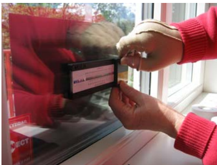
Figur 10 Isolerglasens egenskaper kan kontrolleras, bland annat kan man mäta spaltbredder och registrera var det förekommer metallbeläggningar.
